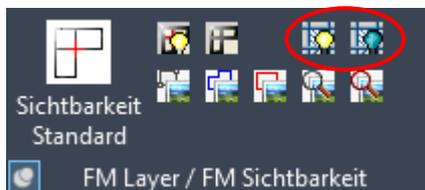
Die Objektschraffur steuert die Sichtbarkeit der Füllungen der Objekte. Bei ausgeschalteter Objektschraffur sind bei Objektsichtbarkeit EIN die Objekte ohne farbige Schraffuren sichtbar.
