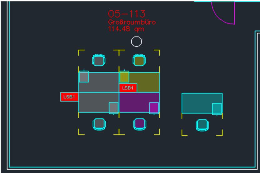
Beim Speichern der Zeichnung mit Datenbank-Abgleich werden die gelöschten und weggeschobenen Objekte komplett aus der Zeichnung entfernt, die neuen und angekommenen Objekte in den Bestand übernommen.
