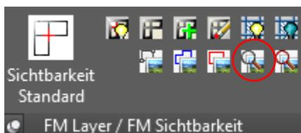
Bei Aufruf des Befehls werden alle Objekte, FM Räume und FM-Polygone, mit Bildergalerie mit einem gelben Polygon oder Pfeil markiert. Die einzelne Bildergalerie wird dann über den Befehl *Bildergalerie* geöffnet.
