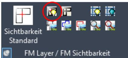
Mit dem Befehl „Objektsichtbarkeit EIN“ werden alle sichtbaren und unsichtbaren Objekte auf **EIN** geschaltet, d.h. neue, gelöschte und verschobene Objekte werden markiert. Standardmäßig sind die Farben wie folgt gesetzt:
