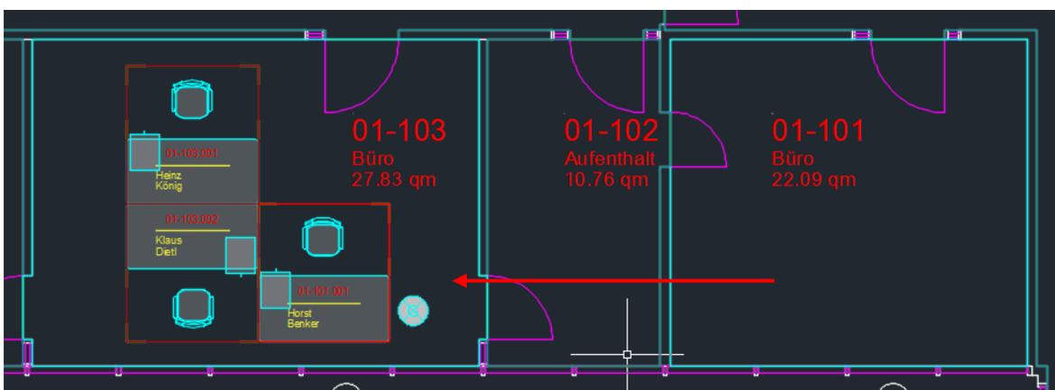
Nach Eingabe des Basispunktes, eines zweiten Punktes (Verschiebung) und des Drehwinkels wird das FM Polygon verschoben.
