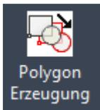
Der Befehl Polygon Erzeugung ergänzt FM-Blöcke mit einem AutoCAD Polygon.
