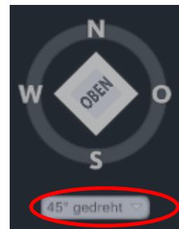
Entweder über diese Dialogbox, oder über den Navigationskompass oben rechts in jeder Zeichnung können Sie nun jederzeit zwischen allen angelegten BKS und dem WKS wechseln.
