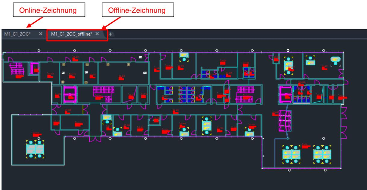
Die Offline Zeichnung kann entweder mit der Online- oder Offline-Konfiguration bearbeitet werden. Um auch ohne Netzanbindung arbeiten zu können, wechseln Sie in den Offline-Modus. Starten Sie dazu den Befehl *DUAL Mode* mit der Option *Konfiguration umschalten* (*Online* → *Offline*)
