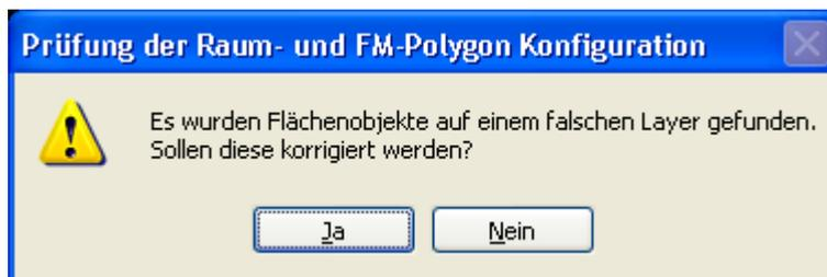
Falsche Raum- und FM-Polygonsymbole müssen mit dem Befehl 'FM-Raumsymbole' bzw. 'FM-Polygon Symbol' mit der Option 'Standard Symbole aktualisieren' bzw. 'FM-Polygon Symbole aktualisieren' durch die richtigen Symbole ersetzt werden.
