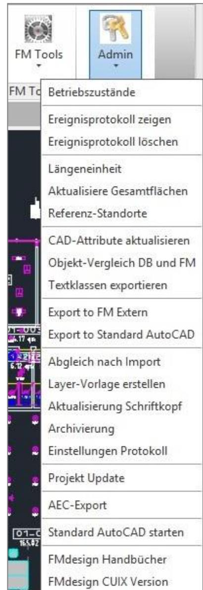
Im Pulldown-Bereich der Gruppe FM Admin befinden sich Funktionen zum Batchlauf, der zerteilten Umgebung, Prüffunktionen für die Zeichnung und die FM-Befehle für Administratoren. Ohne Adminrechte können nur die Prüffunktionen ausgeführt werden, die in einem eigenen Kapitel eingehend beschrieben sind.
