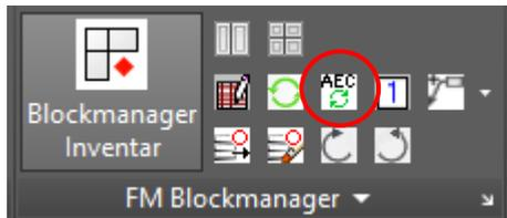
Mit dem Befehl *FM AEC-Objekte aktualisieren* werden sowohl Änderungen im AEC-Objekt sowie im FM-Objekt aktualisiert, eine automatische Standortbestimmung findet statt. Die Auswahl erfolgt mit Eingabe in der Befehlszeile:
